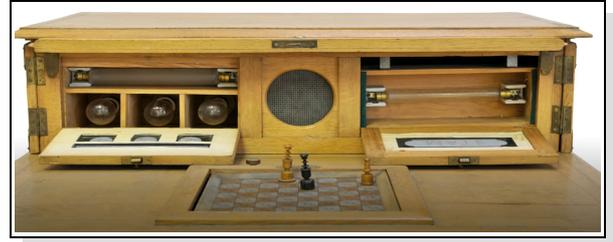
Lorsque le couvercle était rabattu, l'échiquier était bien visible et les pièces se mouvaient automatiquement. Nous découvrons également la grille d'un haut-parleur raccordé à un disque (visible dans le boîtier) qui annonçait le mat final.
